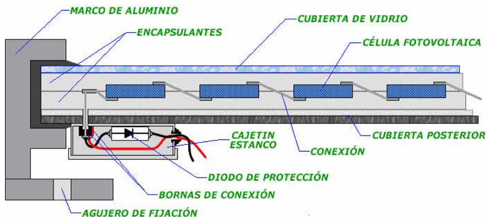
Figura 3.8 Elementos de un panel fotovoltaico
