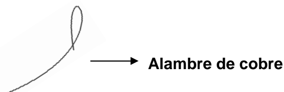
Figura 1.3. Alambre de cobre para la prueba de Beilstein
