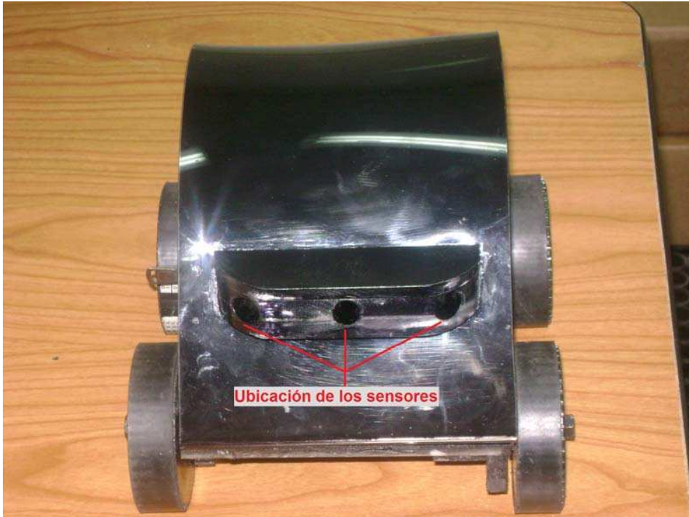
Figura. (4.8). Ubicación de los sensores seguidores del foco de luz en la plataforma
