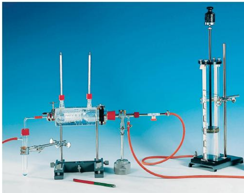
FIGURA No 2. Montaje de formación de CO 2 .
