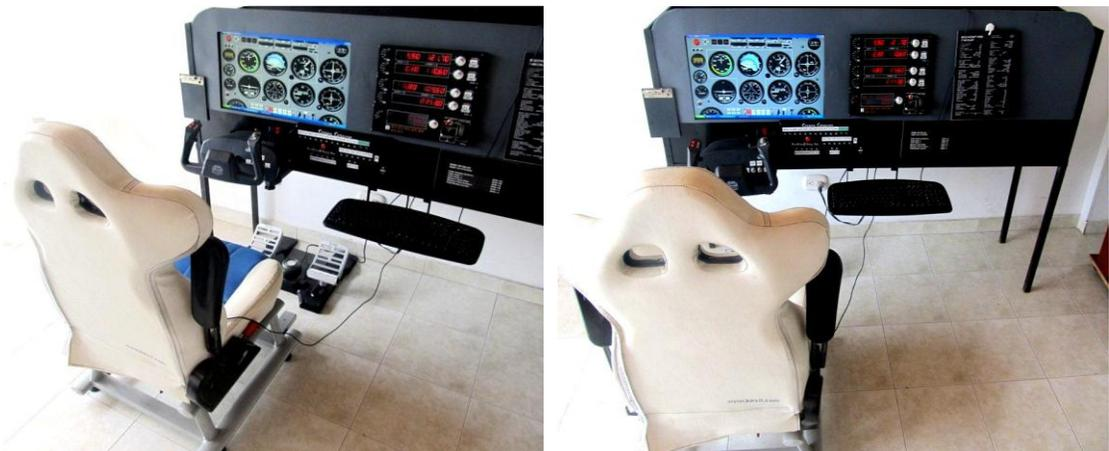
El FTD STÁNDAR TRAINER representa una idea original de construcción de dispositivos entrenadores de vuelo para escuelas de aviación en Colombia. Permite poner a prueba el nivel de habilidad con la mano volando, o con el uso del piloto automático, panel de fallas, instrumentación avanzada (HSI y RMI), switches que son sólo algunas de las características de gran alcance disponibles en este equipo.
