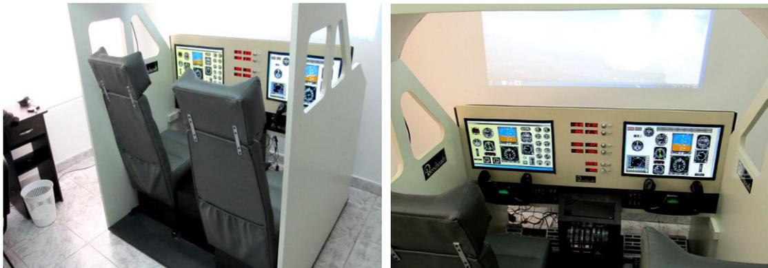
Por su performance y rendimiento ofrece realizar medianas y largas rutas de entrenamiento durante una hora de instrucción. Estructura en madera, sección frontal de aluminio y mecanismo para soporte de monitor en la parte trasera de la cara frontal, sillas con riel para fácil acomodación.
