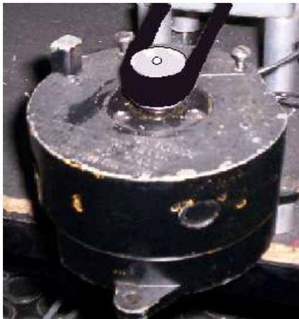
FIGURA 8. MOTOR DC DE 24V CON PIÑÓN ADAPTADO AL EJE
