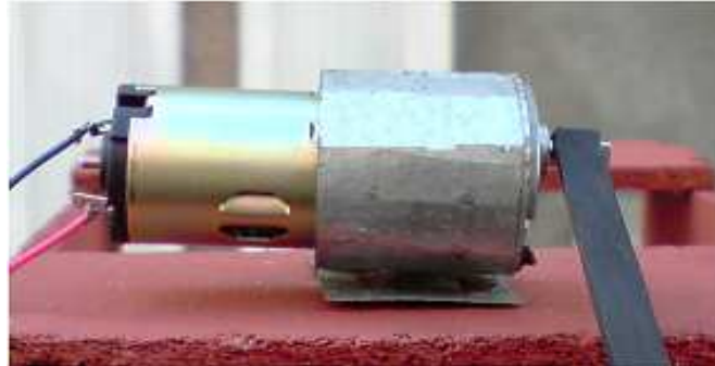
Figura 8. Imagen del motorreductor de la puerta automática.
