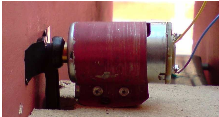
Figura 7. Imagen del motor de la banda transportadora.
